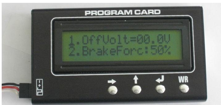
编程卡采用 2X16 字符型液晶显示器，设置界面为菜单方式，配合 4 个按键，可以方便直观地显示、修改各参数项，设置完毕后，可以通过‘写入’键将各参数写到电调中，并永久保存。
