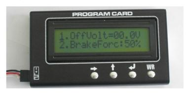
编程卡采用 2X16 字符型液晶显示器,设置界面为菜单方式,配合 4 个按键,可以方便直观地显示、修改各参数项,设置完毕后,可以通过'WR'键将各参数写到电调中,并永久保存。
